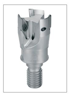
4 Solch ein Werkzeug mit TiB2-basiertem HiPIMS-Schichtwerkstoff AluCon (2 μm Schichtdicke) ist ideal für die Zerspanung von Aluminium, Titan, Kupfer und weiteren NE-Metallen © CemeCon
